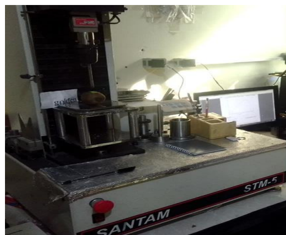
شکل ۱. الف- دستگاه آزمون کشش - فشار، مدل STM-5
