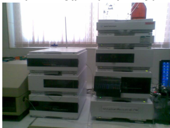
نگاره ۶- دستگاه HPLC جهت اندازه گیری پلی فنل ها
